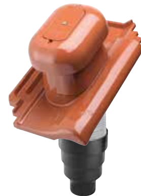
ALU-SYSTEM Sanitärlüfter DN 125 mit abnehmbarem Deckeleinsatz, Anschlussschlauch (70 cm), UD-Manschette und Reduzierstück
