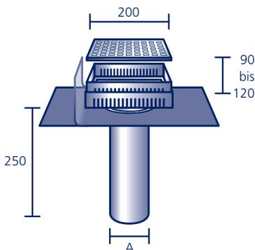
Aus säurefestem Edelstahl V4A, mit werkseitig eingearbeitetem Anschlussstück aus Polybit Kunststoffbitumenschweißbahn oder aus einem anderen Material (siehe Seite 91)\*, **inkl. verzinktem, höhenverstellbarem Revisionschacht und Aluminium-Abdeckung**
