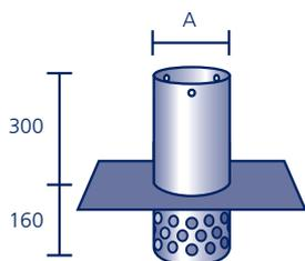
**Kaldachentlüfter-Element**, aus säurefestem Edelstahl V4A, unten geschlossen, um entstehendes Kondenswasser aufzufangen. Mit eingearbeitetem Anschlussstück aus Polybit Kunststoffbitumenschweißbahn oder aus einem anderen Material (siehe Seite 91)\*
