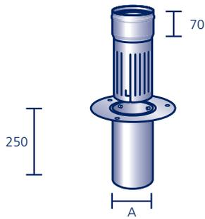
Aus säurefestem Edelstahl V4A, Geschoss-Gully-Grundelement mit Edelstahlflansch und Bajonettverschluss, Aufstockelement mit Muffe und Wasserablaufschlitzen
