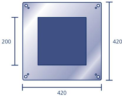
Aus Edelstahl, mit dehnbare EPDM-Folie zur Montage an der Attika, passend für alle Attika-Elemente von 50 bis 160 mm Durchmesser
