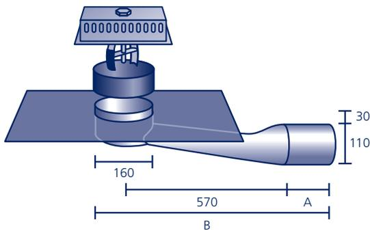
Aus säurefestem Edelstahl V4A, mit werkseitig eingearbeitetem Anschlussstück aus Polybit Kunststoffbitumenschweißbahn oder aus einem anderen Material (siehe Seite 91)\*, **inkl. Laubfang** und **4 Anstauringen** von 25 bis 40 mm. Passende **Dampfsperrplatten** und **Wandscheiben** siehe Seite 37–39. Passendes Dämm-Element siehe **XPS-Montageblock** (Seite 40).
