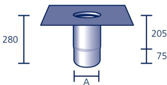
Grundelement aus säurefestem Edelstahl V4A, mit werkseitig eingearbeitetem Anschlussstück aus Polybit Kunststoffbitumenschweißbahn oder aus einem anderen Material (siehe Seite 91)\*
