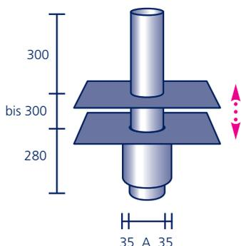
Wärmedämmtes Grundelement (Mineralfaser) und Aufstockelement, jeweils aus säurefestem Edelstahl V4A mit werkseitig eingearbeitetem Anschlussstück aus Polybit Kunststoffbitumenschweißbahn oder aus einem anderen Material (siehe Seite 91)\*, **ohne Haube** (siehe Seite 79)
