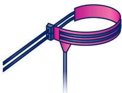
Aus **Glasgewebe und Silikon-Elastomer**, zur Beheizung von Gullys und Rohrleitungen (Durchmesser zwischen 75 und 200 mm). Innenliegendes Heizelement, max. Heizleistung 80°C, Leistungsaufnahme 230 V, max. 8 Watt. Kabellänge 500 mm. Befestigung über zwei integrierte Kabelbinder.
