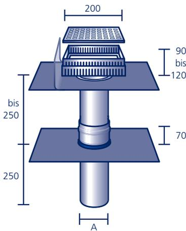
Aus säurefestem Edelstahl V4A, mit werkseitig eingearbeitetem Anschlussstück aus Polybit Kunststoffbitumenschweißbahn oder aus einem anderen Material (siehe Seite 91)\*, **inkl. verzinktem, höhenverstellbarem Revisionschacht und Aluminium-Abdeckung**
