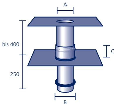
Grundelement mit Muffe und **Rollring** (siehe Seite 41) sowie Aufstockelement, jeweils aus säurefestem Edelstahl V4A mit werkseitig eingearbeitetem Anschlussstück aus Polybit Kunststoffbitumenschweißbahn oder aus einem anderen Material (siehe Seite 91)\*, **ohne Laub-/Kiesfang** (siehe Seite 42/43). Für den Einsatz als Notüberlauf siehe **Anstauringe** (Seite 40).
