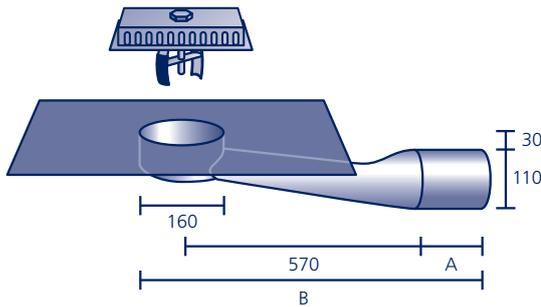
Aus säurefestem Edelstahl V4A mit werkseitig eingearbeitetem Anschlussstück aus Polybit Kunststoffbitumenschweißbahn oder aus einem anderen Material (siehe Seite 91)\*, **inkl. Laubfang**. Passende **Dampfsperrplatten** und **Wandscheiben** siehe Seite 37–39. Passendes Dämm-Element siehe **XPS-Montageblock** (Seite 40).
