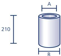
Dämmhülse aus Edelstahl mit Mineralfaserkern (35 mm stark), wird über den unterhalb der Dachfläche liegenden Stützen geschoben
