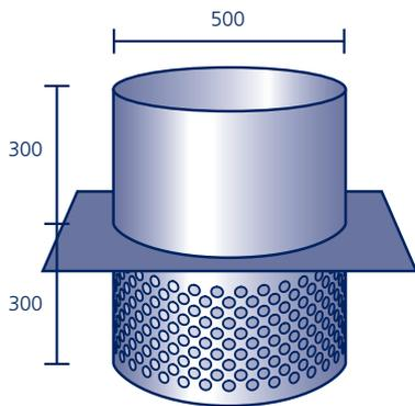
**Kaltdachentlüfter-Element**, aus säurefestem Edelstahl V4A, unten geschlossen, um entstehendes Kondenswasser aufzufangen. Mit werkseitig eingearbeitetem Anschlussstück aus Polybit Kunststoffbitumenschweißbahn oder aus einem anderen Material (siehe Seite 91)\*
