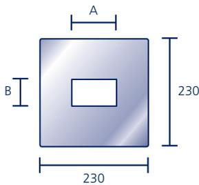
Aus Edelstahl, zur Abdeckung einer Mauerdurchführung, passend für Keil-Speier
