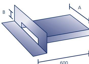
Aus V4A-Edelstahl. Individuelle Ausführungen (z. B. andere Stutzenmaße, 2 x 45°-Abkantung des Flansches, Schrägschnitt des Stutzens) sind möglich\*. Passende **Dampfsperrplatten** und **Wandscheiben** siehe Seite 37–39. **Wasserfangkästen** in Stutzengröße auf Anfrage
