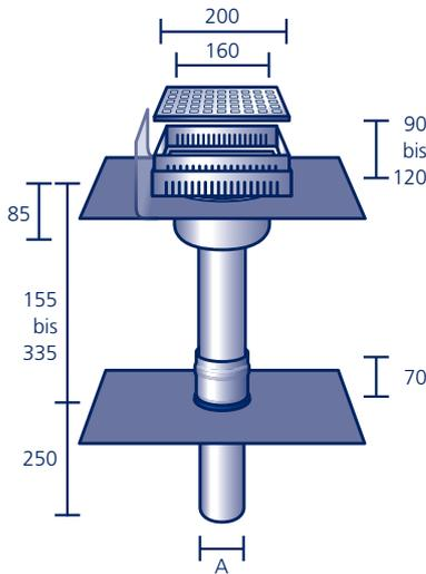
Aus säurefestem Edelstahl V4A, mit werkseitig eingearbeitetem Anschlussstück aus Polybit Kunststoffbitumenschweißbahn oder aus einem anderen Material (siehe Seite 91)\*, **inkl. verzinktem, höhenverstellbarem Revisionschacht und Edelstahl-Abdeckung**
