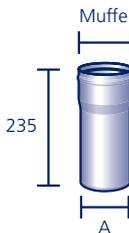
Aus säurefestem Edelstahl V4A, mit EPDM-Lippendichtung
