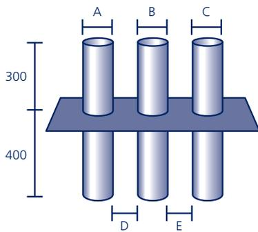
Aus säurefestem Edelstahl V4A mit werkseitig eingearbeitetem Anschlussstück aus Polybit Kunststoffbitumenschweißbahn oder aus einem anderen Material (siehe Seite 91)\*, **ohne Hauben** (siehe Seite 79). Das Multi-Dunstrohr wird individuell nach Vorgabe gefertigt\*. Bitte geben Sie die Maße A, B und C (75, 110, 125 oder 160 mm) sowie die Abstände D und E (mind. 50 mm) an.
