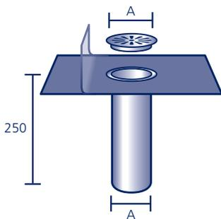
Aus säurefestem Edelstahl V4A, mit werkseitig eingearbeitetem Anschlussstück aus Polybit Kunststoffbitumenschweißbahn oder aus einem anderen Material (siehe Seite 91)\*, **inkl. Edelstahl-Rost**
