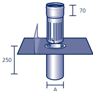
Aus säurefestem Edelstahl V4A, Geschoss-Gully-Grundelement mit Bajonettverschluss und werkseitig eingearbeitetem Anschlussstück aus Polybit Kunststoffbitumenschweißbahn oder aus einem anderen Material (siehe Seite 91)\*, Aufstockelement mit Muffe und Wasserablaufschlitzen
