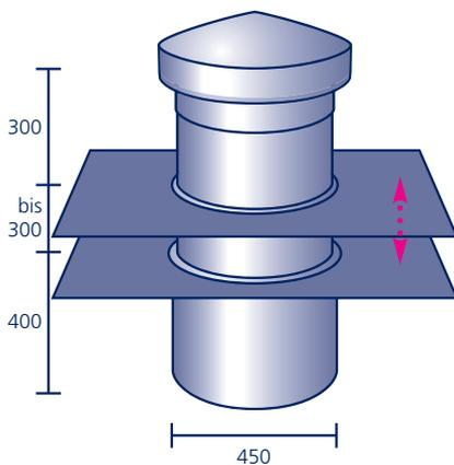
Grundelement und Aufstockelement aus säurefestem Edelstahl V4A, mit Wärmedämmung (Elastomerschaum) im oberen Stutzen und werkseitig eingearbeitetem Anschlussstück aus Polybit Kunststoffbitumenschweißbahn oder aus einem anderen Material (siehe Seite 91)\*. **Inkl. V4A-Haube**, schlagregensicher
