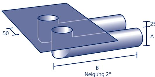
Aus säurefestem Edelstahl V4A, mit werkseitig eingearbeitetem Anschlussstück aus Polybit Kunststoffbitumenschweißbahn oder aus einem anderen Material (siehe Seite 91)\*, **ohne Laub-/Kiesfang** (siehe Seite 42/43). Passende **Doppel-Wasserrückhalteboxen** siehe Seite 36, **Dampfsperrplatten** und **Wandscheiben** siehe Seite 37–39. Für den Einsatz als Notüberlauf siehe **Anstauring** (Seite 40).
