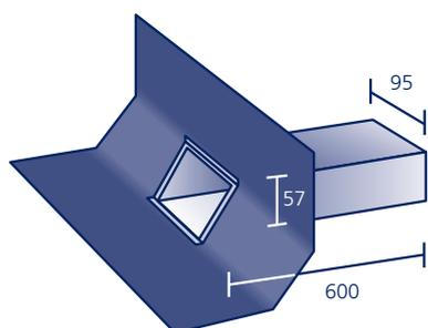
Aus V4A-Edelstahl mit werkseitig eingearbeitetem Anschlussstück aus Polybit Kunststoffbitumenschweißbahn. Individuelle Ausführungen (andere Stützenlängen, Schrägschnitt des Stützens) sind möglich\*. **Ohne Laub-/Kiesfang** (siehe Seite 42/43). Passende **Dampfsperplatten** und **Wandscheiben** siehe Seite 37–39. Passendes **Übergangsstück von Eckig auf Rund** siehe Seite 32.
