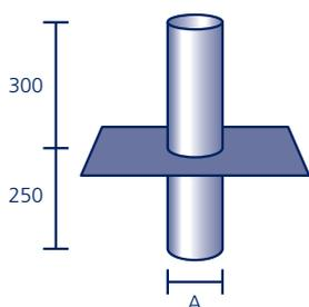
Aus säurefestem Edelstahl V4A mit werkseitig eingearbeitetem Anschlussstück aus Polybit Kunststoffbitumenschweißbahn oder aus einem anderen Material (siehe Seite 91)\*, **ohne Haube** (siehe Seite 79)
