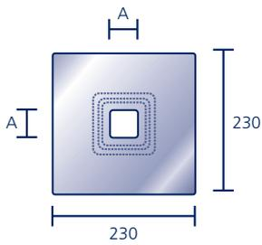
Aus Edelstahl, zur Abdeckung einer Mauerdurchführung, passend für die Übergangsstücke rund/quadratisch
