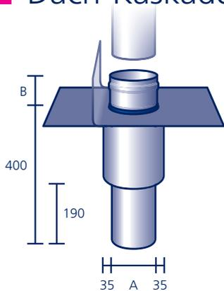
Aus säurefestem Edelstahl V4A, mit Muffe und werkseitig eingearbeitetem Anschlussstück aus Polybit Kunststoffbitumenschweißbahn oder aus einem anderen Material (siehe Seite 91)\*, wärmegeädämmt (Mineralfaser).
