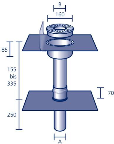
Aus säurefestem Edelstahl V4A, mit werkseitig eingearbeitetem Anschlussstück aus Polybit Kunststoffbitumenschweißbahn oder aus einem anderen Material (siehe Seite 911)\*, **inkl. Edelstahl-Rost mit Rohr-Ausschnitt und Hebetechnik** zur Befestigung des Fallrohrs
