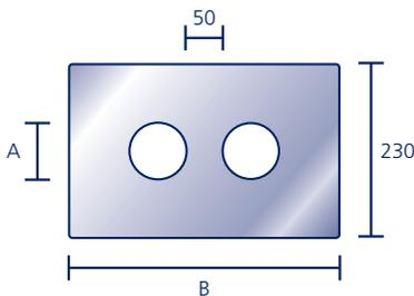
Aus Edelstahl, zur Abdeckung des Ringspaltes, passend für Doppel-Elemente
