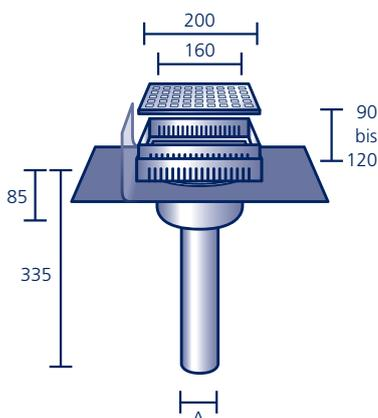
Aus säurefestem Edelstahl V4A, mit werkseitig eingearbeitetem Anschlussstück aus Polybit Kunststoffbitumenschweißbahn oder aus einem anderen Material (siehe Seite 91)\*, **inkl. verzinktem, höhenverstellbarem Revisionsschacht und Edelstahl-Abdeckung**
