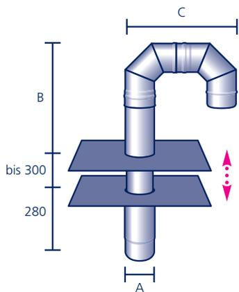
Aus säurefestem Edelstahl V4A mit werkseitig eingearbeitetem Anschlussstück aus Polybit Kunststoffbitumenschweißbahn oder aus einem anderen Material (siehe Seite 91)\*, bestehend aus Grundelement und Dunstrohr mit zwei Bögen 90°, auch mit drei 45°-Bögen\* lieferbar
