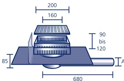
Aus säurefestem Edelstahl V4A, mit werkseitig eingearbeitetem Anschlussstück aus Polybit Kunststoffbitumenschweißbahn oder aus einem anderen Material (siehe Seite 91)\*, **inkl. verzinktem, höhenverstellbarem Revisionschacht** und **Edelstahl-Abdeckung**. Passende **Wandrosetten** und **Wandscheiben** siehe Seite 71.
