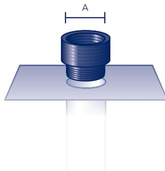
**EPDM-Anstauring.** Variable Anstauhöhe durch Schneidmarkierungen in 10-mm-Schritten von 25 bis 75 mm. Passende Laubfänge: **M-Laubfang erhöht/Kiesdach** und **VARIO S** siehe Seite 42
