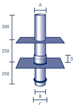
Grundelement mit Muffe und **Rollring** (siehe Seite 41) sowie Aufstockelement, jeweils aus säurefestem Edelstahl V4A mit werkseitig eingearbeitetem Anschlussstück aus Polybit Kunststoffbitumenschweißbahn (oder aus einem anderen Material (siehe Seite 91)\*, **ohne Haube** (siehe Seite 79)
