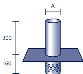
Aus säurefestem Edelstahl V4A, unten geschlossen, um entstehendes Kondenswasser aufzufangen. Die Luftzirkulation erfolgt durch die rundherum angeordneten Öffnungen in der senkrechten Wand des Rohrs. Mit werkseitig eingearbeitetem Anschlussstück aus Polybit Kunststoffbitumenschweißbahn oder aus einem anderen Material (siehe Seite 91)\*, **ohne Haube** (siehe Seite 79)
