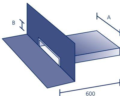
Aus V4A-Edelstahl mit werkseitig eingearbeitetem Anschlussstück aus Polybit Kunststoffbitumen-schweißbahn oder aus Resitrix (siehe Seite 91)\*. Individuelle Ausführungen (z. B. andere Stutzenmaße, Schrägschnitt des Stutzens) sind möglich\*. Passende **Dampfsperrplatten** und **Wandscheiben** siehe Seite 37–39. **Wasserfangkästen** in Stutzengröße auf Anfrage
