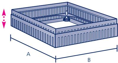
**Grundelement, Stelzlager**, höhenverstellbar 90–120 mm
