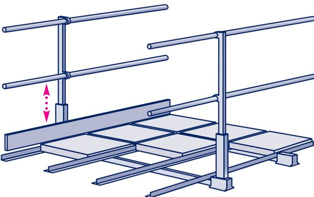
**Flucht-, Rettungs- oder Wartungsweg** mit Plattenbelag als Auflast (nicht inkl.), mit ein- oder beidseitiger höhenverstellbarer Geländerführung, gemäß DIN ISO 14094-2; Alu, natur; Lackierung in RAL-Farben gegen Aufpreis möglich\*.
