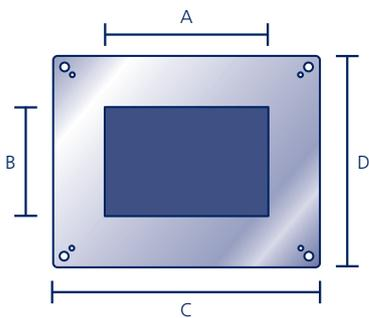
Aus Edelstahl, mit dehnbare EPDM-Folie zur Montage an der Attika, passend für Speier
