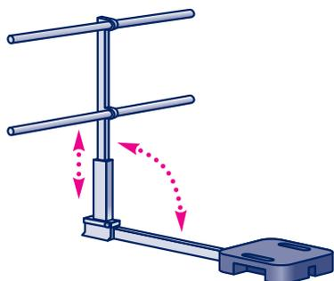
**Selbsttragendes, höhenverstellbares, klappbares Geländer-System** für nicht begehbare Flachdächer und Terrassen **mit einer mind. 150 mm hohen Attika**, gemäß DIN EN 14122-3 – Schutzklasse A; Alu, natur; Lackierung in RAL-Farben gegen Aufpreis möglich\*.
