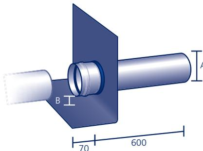
Aus säurefestem Edelstahl V4A mit Muffe und werkseitig eingearbeitetem Anschlussstück aus Polybit Kunststoffbitumenschweißbahn oder aus einem anderen Material (siehe Seite 91)\*, inkl. werkseitiger 90°-Abkantung, exakt auf Wunsch-Abkantungshöhe B (mind. 20 mm). Passende **Dampfsperrplatten** und **Wandscheiben** siehe Seite 37–39.
