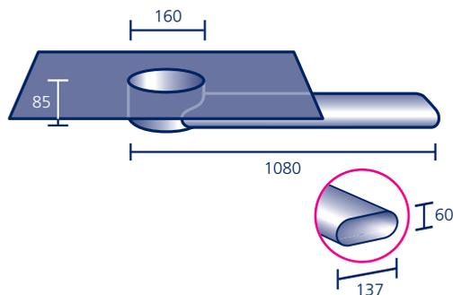
Aus säurefestem Edelstahl V4A mit werkseitig eingearbeitetem Anschlussstück aus Polybit Kunststoffbitumenschweißbahn oder aus einem anderen Material (siehe Seite 91)\*, **ohne Laub-/Kiesfang** (siehe Seite 42/43). Passende **Dampfsperrplatten** und **Wandscheiben** siehe Seite 37–39. Für den Einsatz als Notüberlauf siehe **Anstauringe** (Seite 40). Passendes **Übergangsstück von Oval auf Rund** siehe Seite 32. Passendes Dämm-Element siehe **XPS-Montageblock** (Seite 40).
