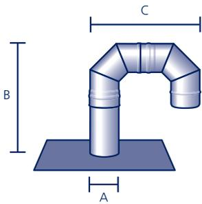
Aus säurefestem Edelstahl V4A mit werkseitig eingearbeitetem Anschlussstück aus Polybit Kunststoffbitumenschweißbahn oder aus einem anderen Material (siehe Seite 91)\*, bestehend aus Dachentlüfter mit zwei Bögen 90°, auch mit drei 45°-Bögen\* lieferbar
