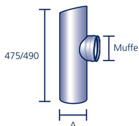
87,5°, aus **Zink blank**, mit Lochblechabdeckung und EPDM-Lippendichtung (nur in der Muffenverbindung); auch aus Kupfer\*, Aluminium\* und FTE\* lieferbar (Preise auf Anfrage)
