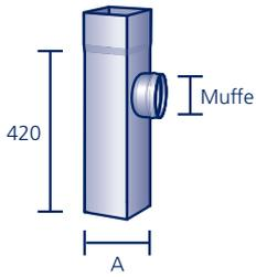
87,5°, aus **Zink blank**, mit EPDM-Lippendichtung (nur in der Muffenverbindung); zum Anschluss an Regenfallrohre oben und unten; auch aus Kupfer\*, Aluminium\* und FTE\* lieferbar (Preise auf Anfrage)
