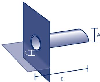
Aus säurefestem Edelstahl V4A, mit 45°-Schrägschnitt, werkseitig eingearbeitetes Anschlussstück aus flexibler Kunststoffbitumenschweißbahn mit eingearbeitetem Streckmetall zur einfachen Abkantung (Maß C mind. 20 mm). Auch andere Materialien mit flexiblem Anschlussstück sind möglich (siehe Seite 91)\*, **ohne Kiesfang** (siehe Seite 71). Passende **Wandrosetten** und **Wandscheiben** siehe Seite 71.
