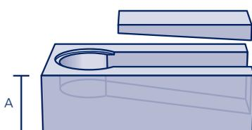
Aus extrudiertem Polystyrol zur einfachen und sicheren Dämmung von Attika-Gully (siehe Seite 27), Attika-Ablauf, Attika-Notüberlauf, Attika-Flach-Ablauf (siehe Seite 28) und Topf-Gully, waagrecht (siehe Seite 21)
