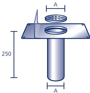
Aus säurefestem Edelstahl V4A, mit Anschlussstück aus Edelstahl V4A, **inkl. Edelstahl-Rost**
