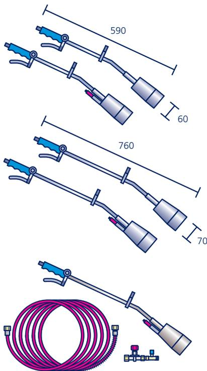
**Kurzstielbrenner** aus verzinktem Stahl, Gewicht 890 g, Betriebsdruck 2–4 bar, Verbrauch bei 4 bar 7,8 kg/h, Wärmeleistung 92 kW
