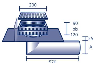
Aus säurefestem Edelstahl V4A, mit werkseitig eingearbeitetem Anschlussstück aus Polybit Kunststoffbitumenschweißbahn oder aus einem anderen Material (siehe Seite 91)\*, **inkl. verzinktem, höhenverstellbarem Revisionschacht** und **Aluminium-Abdeckung**. Passende **Wandrosetten** und **Wandscheiben** siehe Seite 71.
