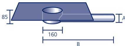
Aus säurefestem Edelstahl V4A, mit werkseitig eingearbeitetem Anschlussstück aus Polybit Kunststoffbitumenschweißbahn oder aus einem anderen Material (siehe Seite 91)\*, **ohne Laub-/Kiesfang** (siehe Seite 42/43). Passende **Dampfsperrplatten** und **Wandscheiben** siehe Seite 37–39. Für den Einsatz als Notüberlauf siehe **Anstauringe** (Seite 40). Passendes Dämm-Element siehe **XPS-Montageblock** (Seite 40).
