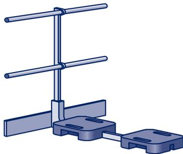
**Selbsttragendes Geländer-System** für nicht begehbare Flachdächer und Terrassen (max. 2% Neigung) **ohne Attika**, gem. DIN EN 13374 – Schutzklasse A, **inkl. Fußleiste und Doppelgewichten**; Alu, natur; Lackierung in RAL-Farben gegen Aufpreis möglich\*
