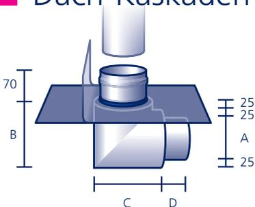
Aus säurefestem Edelstahl V4A, mit Muffe und werkseitig eingearbeitetem Anschlussstück aus Polybit Kunststoffbitumenschweißbahn oder aus einem anderen Material (siehe Seite 91)\*, wärmegeklämt (EPS)
