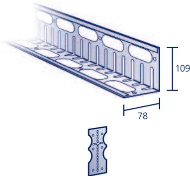
Die **Kiesleiste** hält das Substrat auf dem Dach, während das Regenwasser ungehindert durch die gestanzten Langlöcher ablaufen kann, Länge 2500 mm
