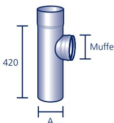
87,5°, aus **Zink blank**, mit Regenrohrmuffe und EPDM-Lippendichtung (nur in der Muffenverbindung); auch aus Kupfer\*, Aluminium\* und FTE\* lieferbar (Preise auf Anfrage)
