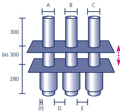
Wärmedämmte Grundelemente (Mineralfaser) und Aufstockelemente, jeweils aus säurefestem Edelstahl V4A mit werkseitig eingearbeitetem Anschlussstück aus Polybit Kunststoffbitumenschweißbahn oder aus einem anderen Material (siehe Seite 91)\*, **ohne Hauben** (siehe Seite 79). Das Multi-Dunstrohr-System wird individuell nach Vorgabe gefertigt\*. Bitte geben Sie die Maße A, B und C (75, 110, 125 oder 160 mm) sowie die Abstände D und E (mind. 70 mm) an.
