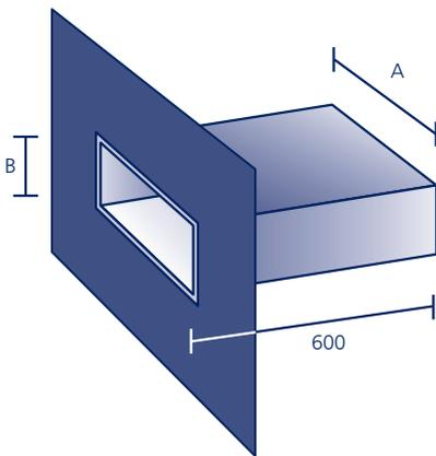
Aus V4A-Edelstahl mit werkseitig eingearbeitetem Anschlussstück aus Polybit Kunststoffbitumen-schweißbahn. Individuelle Ausführungen (z. B. andere Stutzenmaße, Schrägschnitt des Stutzens) sind möglich\*. Passende **Dampfsperrplatten** und **Wandscheiben** siehe Seite 37–39.
