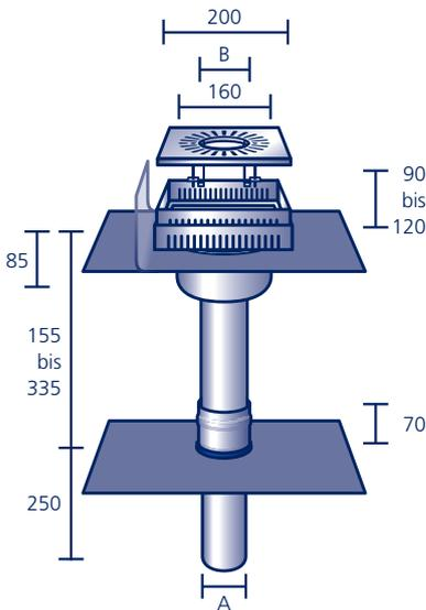
Aus säurefestem Edelstahl V4A, mit werkseitig eingearbeitetem Anschlussstück aus Polybit Kunststoffbitumenschweißbahn oder aus einem anderen Material (siehe Seite 911)\*, **inkl. verzinktem, höhenverstellbarem Revisionschacht und Edelstahl-Abdeckung mit Rohr-Ausschnitt und Hebetechnik** zur Befestigung des Fallrohrs
