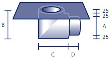
Aus säurefestem Edelstahl V4A, mit werkseitig eingearbeitetem Anschlussstück aus Polybit Kunststoffbitumenschweißbahn oder aus einem anderen Material (siehe Seite 91)\*, wärmegeklämt (EPS), **ohne Laub-/Kiesfang** (siehe Seite 42/43). Für den Einsatz als Notüberlauf siehe **Anstauringe** (Seite 40).
