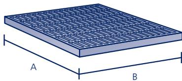
**Abdeckung, Gitterrost**, Belastungsklasse K3
