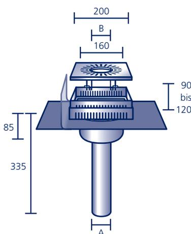
Aus säurefestem Edelstahl V4A, mit werkseitig eingearbeitetem Anschlussstück aus Polybit Kunststoffbitumenschweißbahn oder aus einem anderen Material (siehe Seite 91)\*, **inkl. verzinktem, höhenverstellbarem Revisionschacht und Edelstahl-Abdeckung mit Rohr-Ausschnitt und Hebetechnik** zur Befestigung des Fallrohrs
