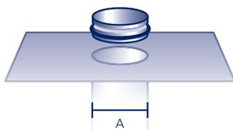
**Anstauring** aus säurefestem Edelstahl V4A mit EPDM-Ring; für den Einsatz von Dachgullys, Dachgully-Systemen und Attika-Gullys als Notüberlauf; Anstauhöhe wahlweise 25 oder 35 mm. Passende Laubfänge: **M-Laubfang erhöht/Kiesdach** und **VARIO S** siehe Seite 42
