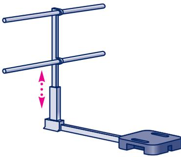
**Selbsttragendes, höhenverstellbares Geländer-System** für nicht begehbare Flachdächer und Terrassen **mit einer mind. 150 mm hohen Attika**, gemäß DIN EN 13374 – Schutzklasse A; Alu, natur; Lackierung in RAL-Farben gegen Aufpreis möglich\*.
