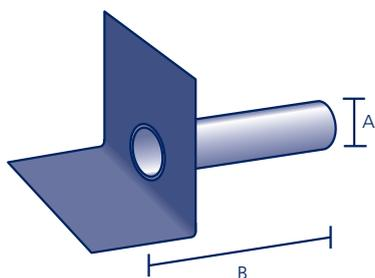
Aus säurefestem Edelstahl V4A, mit werkseitig eingearbeitetem Anschlussstück aus Polybit Kunststoffbitumenschweißbahn oder aus einem anderen Material (siehe Seite 91)\*, **ohne Kiesfang** (siehe Seite 71). Passende **Wandrosetten** und **Wandscheiben** siehe Seite 71.
