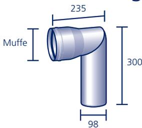
Aus säurefestem Edelstahl V4A, mit EPDM-Lippendichtung
