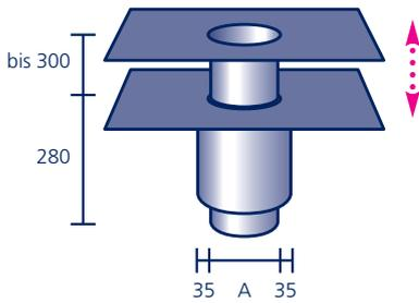
Wärmeisoliertes Grundelement (Mineralfaser), Aufstockelement aus säurefestem Edelstahl V4A mit werkseitig eingearbeitetem Anschlussstück aus Polybit Kunststoffbitumenschweißbahn oder aus einem anderen Material (siehe Seite 91)\*, **ohne Laub-/Kiesfang** (siehe Seite 42/43). Für den Einsatz als Notüberlauf siehe **Anstauringe** (Seite 40).
