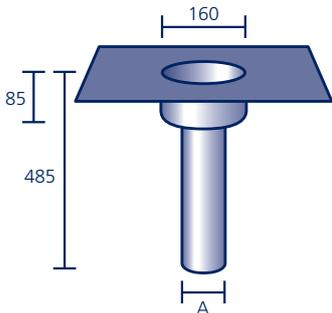
Aus säurefestem Edelstahl V4A, mit werkseitig eingearbeitetem Anschlussstück aus Polybit Kunststoffbitumenschweißbahn oder aus einem anderen Material (siehe Seite 91)\*, **ohne Laub-/Kiesfang** (siehe Seite 42/43). Für den Einsatz als Notüberlauf siehe **Anstauringe** (Seite 40).
