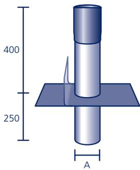
Aus säurefestem Edelstahl V4A mit Schrumpfhülse (max. 100 °C) zur einfachen, sicheren Abdichtung, mit werkseitig eingearbeitetem Anschlussstück aus Polybit Kunststoffbitumenschweißbahn oder aus einem anderen Material (siehe Seite 91)\*
