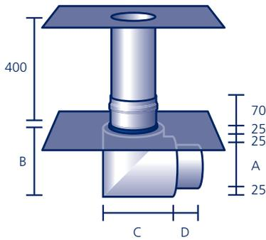
Wärmeisoliertes Grundelement (EPS) mit Muffe sowie Aufstockelement, jeweils aus säurefestem Edelstahl V4A mit werkseitig eingearbeitetem Anschlussstück aus Polybit Kunststoffbitumenschweißbahn oder aus einem anderen Material (siehe Seite 91)\*, **ohne Laub-/Kiesfang** (siehe Seite 42/43). Für den Einsatz als Notüberlauf siehe **Anstauringe** (Seite 40).
