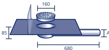
Aus säurefestem Edelstahl V4A, mit werkseitig eingearbeitetem Anschlussstück aus Polybit Kunststoffbitumenschweißbahn oder aus einem anderen Material (siehe Seite 91)\*, **inkl. Edelstahl-Rost**. Passende **Wandrosetten** und **Wandscheiben** siehe Seite 71.
