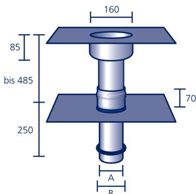
Grundelement mit Muffe und **Rollring** (siehe Seite 41) sowie Aufstockelement, jeweils aus säurefestem Edelstahl V4A mit werkseitig eingearbeitetem Anschlussstück aus Polybit Kunststoffbitumenschweißbahn oder aus einem anderen Material (siehe Seite 91)\*, **ohne Laub-/Kiesfang** (siehe Seite 42/43). Für den Einsatz als Notüberlauf siehe **Anstauringe** (Seite 40).
