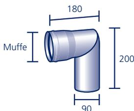
Aus säurefestem Edelstahl V4A, mit EPDM-Lippendichtung
