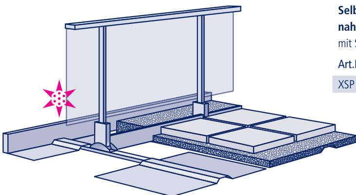
**Selbsttragendes Geländer** für Flachdachterrassen **mit Lastaufnahmeblechen** für z. B. Plattenbelag als Auflast (nicht inkl.); Geländer mit Stab- oder Glasfüllung; Lackierung in RAL-Farbe\*
