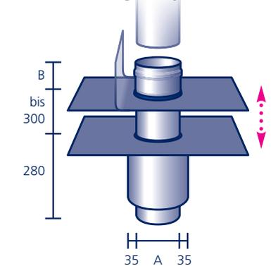
Wärmeisoliertes Grundelement (Mineralfaser) sowie Aufstockelement mit Muffe, jeweils aus säurefestem Edelstahl V4A mit werkseitig eingearbeitetem Anschlussstück aus Polybit Kunststoffbitumenschweißbahn oder aus einem anderen Material (siehe Seite 91)\*
