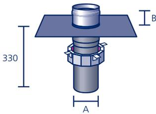
Brandschutz-Grundelement R90 aus PVC mit Muffe aus säurefestem Edelstahl V4A, mit werkseitig eingearbeitetem Anschlussstück aus Polybit Kunststoffbitumenschweißbahn oder aus einem anderen Material (siehe Seite 91)\*
