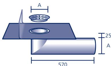
Aus säurefestem Edelstahl V4A, mit werkseitig eingearbeitetem Anschlussstück aus Polybit Kunststoffbitumenschweißbahn oder aus einem anderen Material (siehe Seite 91)\*, **inkl. Edelstahl-Rost**. Passende **Wandrosetten** und **Wandscheiben** siehe Seite 71.
