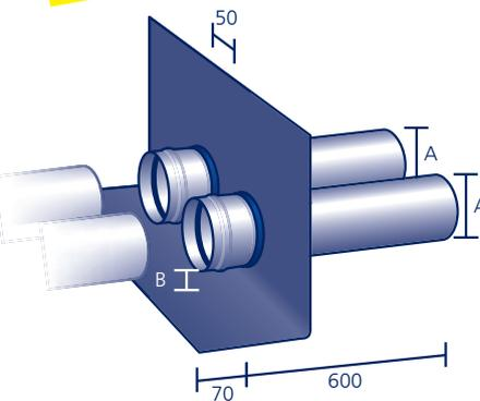
Aus säurefestem Edelstahl V4A mit Muffen und werkseitig eingearbeitetem Anschlussstück aus Polybit Kunststoffbitumenschweißbahn oder aus einem anderen Material (siehe Seite 91)\*, inkl. werkseitiger 90°-Abkantung, exakt auf Wunsch-Abkantungshöhe B (mind. 20 mm). Passende **Doppel-Wasserfangkästen** siehe Seite 36, **Dampfsperrplatten** und **Wandscheiben** siehe Seite 37–39.
