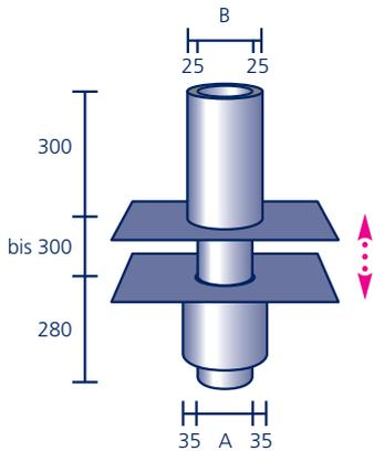
Grundelement, wärmege-dämmt (Mineralfaser,) und Aufstockelement, oberer Stutzen wärmege-dämmt (Elastomerschaum), jeweils aus säurefestem Edelstahl V4A und mit werkseitig eingearbeitetem Anschlussstück aus Polybit Kunststoffbitumenschweißbahn oder aus einem anderen Material (siehe Seite 91)\*, **ohne Haube** (siehe Seite 79)
