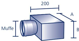
Aus säurefestem Edelstahl V4A, mit EPDM-Lippendichtung. Kann senkrecht und waagrecht eingesetzt werden. Wird exakt nach Vorgabe gefertigt\*. Wenn die Abflussleistung nicht reduziert werden soll, müssen die Maße A und B mindestens dem Durchmesser des vorhandenen Ablaufs entsprechen.
