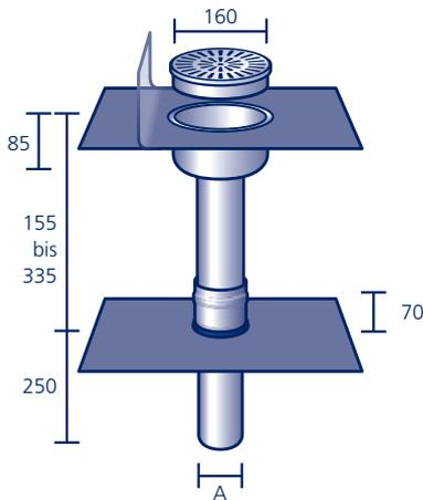
Aus säurefestem Edelstahl V4A, mit werkseitig eingearbeitetem Anschlussstück aus Polybit Kunststoffbitumenschweißbahn oder aus einem anderen Material (siehe Seite 91)\*, **inkl. Edelstahl-Rost**
