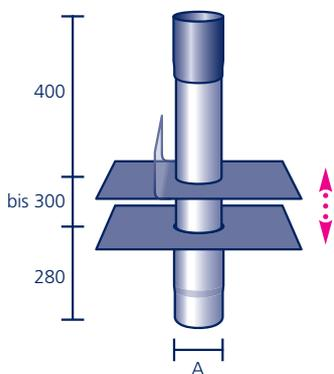
Aus säurefestem Edelstahl V4A mit Schrumpfhülse (max. 100 °C) zur einfachen, sicheren Abdichtung, mit werkseitig eingearbeitetem Anschlussstück aus Polybit Kunststoffbitumenschweißbahn oder aus einem anderen Material (siehe Seite 91)\*
