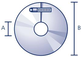
Aus Edelstahl, zur Abdeckung des Ringspaltes, verstellbar, passend für runde Attika-Elemente
