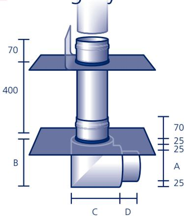
Wärmeisoliertes Grundelement (EPS) mit Muffe sowie Aufstockelement mit Muffe, jeweils aus säurefestem Edelstahl V4A mit werkseitig eingearbeitetem Anschlussstück aus Polybit Kunststoffbitumenschweißbahn oder aus einem anderen Material (siehe Seite 91)\*, **ohne Laub-/Kiesfang** (siehe Seite 42/43)
