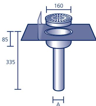
Aus säurefestem Edelstahl V4A, mit werkseitig eingearbeitetem Anschlussstück aus Polybit Kunststoffbitumenschweißbahn oder aus einem anderen Material (siehe Seite 91)\*, **inkl. Edelstahl-Rost**
