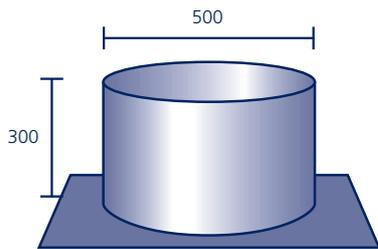
**Dachentlüfter-Element**, aus säurefestem Edelstahl V4A, mit werkseitig eingearbeitetem Anschlussstück aus Polybit Kunststoffbitumenschweißbahn oder aus einem anderen Material (siehe Seite 91)\*
