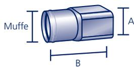
Aus säurefestem Edelstahl V4A, mit EPDM-Lippendichtung in der Muffe. Kann senkrecht und waagrecht eingesetzt werden. Passende **Dampfsperplatten** und **Wandscheiben** siehe Seite 37–39.
