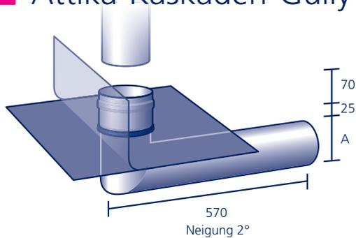
Aus **säurefestem Edelstahl V4A**, mit Muffe und werkseitig eingearbeitetem Anschlussstück aus Polybit Kunststoffbitumenschweißbahn oder aus einem anderen Material (siehe Seite 91)\*. Passende **Dampfsperrplatten** und **Wandscheiben** siehe Seite 37–39. Passendes Dämm-Element siehe **XPS-Montageblock** (Seite 40).
