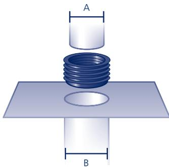
**Rückstaudichtung** aus EPDM. Anstelle eines Rollrings zur sicheren Verbindung eines Aufstockelements mit einem Element oder vorhandenem Rohr
