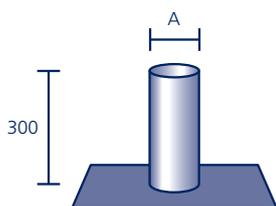
Aus säurefestem Edelstahl V4A mit werkseitig eingearbeitetem Anschlussstück aus Polybit Kunststoffbitumenschweißbahn oder aus einem anderen Material (siehe Seite 91)\*, **ohne Haube** (siehe Seite 79)
