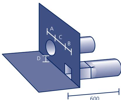
Aus säurefestem Edelstahl V4A mit werkseitig eingearbeitetem Anschlussstück aus Polybit Kunststoffbitumenschweißbahn, aus PVC, aus PIB oder aus Resitrix (siehe Seite 91)\*, **ohne Laub-/Kiesfang** (siehe Seite 42/43). Die Attika-Doppelemente werden exakt nach Vorgabe gefertigt\*, bitte geben Sie die Maße A, B, C (mind. 50 mm) und D (mind. 20 mm) an.
