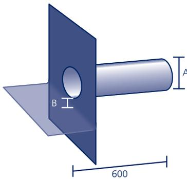
Aus säurefestem Edelstahl V4A mit werkseitig eingearbeitetem Anschlussstück aus flexibler Kunststoffbitumenschweißbahn mit eingearbeitetem Streckmetall zur einfachen Abkantung (Anstauhöhe B mind. 20 mm). Auch andere Materialien mit flexiblem Anschlussstück sind möglich (siehe Seite 91)\*.
