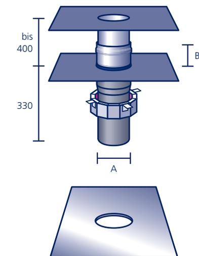
Brandschutz-Grundelement R90 aus PVC mit Muffe aus säurefestem Edelstahl V4A, Aufstockelement aus säurefestem Edelstahl V4A, jeweils mit werkseitig eingearbeitetem Anschlussstück aus Polybit Kunststoffbitumenschweißbahn oder aus einem anderen Material (siehe Seite 91)\*, **ohne Laub-/Kiesfang** (siehe Seite 42/43). Für den Einsatz als Notüberlauf siehe **Anstauringe** (Seite 40).
