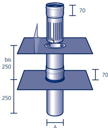
Aus säurefestem Edelstahl V4A, Geschoss-Gully-Grundelement mit Bajonettverschluss und Grundelement mit Muffe, jeweils mit werkseitig eingearbeitetem Anschlussstück aus Polybit Kunststoffbitumenschweißbahn oder aus einem anderen Material (siehe Seite 91)\*, Aufstockelement mit Muffe und Wasserablaufschlitzen.
