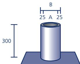
Aus säurefestem Edelstahl V4A mit Wärmedämmung (Elastomerschaum) im Stutzen und werkseitig eingearbeitetem Anschlussstück aus Polybit Kunststoffbitumenschweißbahn oder aus einem anderen Material (siehe Seite 91)\*, **ohne Haube** (siehe Seite 79)
