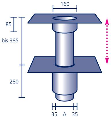
Wärmeisoliertes Grundelement (Mineralfaser), Aufstockelement aus säurefestem Edelstahl V4A mit werkseitig eingearbeitetem Anschlussstück aus Polybit Kunststoffbitumenschweißbahn oder aus einem anderen Material (siehe Seite 91)\*, **ohne Laub-/Kiesfang** (siehe Seite 42/43). Für den Einsatz als Notüberlauf siehe **Anstauringe** (Seite 40).
