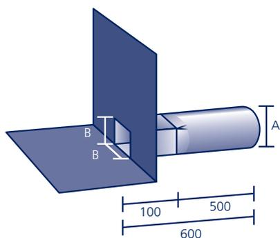
Aus säurefestem Edelstahl V4A mit werkseitig eingearbeitetem Anschlussstück aus Polybit Kunststoffbitumenschweißbahn oder aus einem anderen Material (siehe Seite 91)\*, **ohne Laub-/Kiesfang** (siehe Seite 42/43). Passende **Dampfsperplatten** und **Wandscheiben** siehe Seite 37–39.
