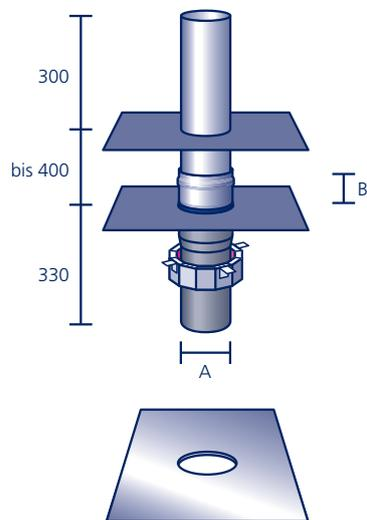
Brandschutz-Grundelement R90 aus PVC mit Muffe aus säurefestem Edelstahl V4A, Aufstockelement aus säurefestem Edelstahl V4A, jeweils mit werkseitig eingearbeitetem Anschlussstück aus Polybit Kunststoffbitumenschweißbahn oder aus einem anderen Material (siehe Seite 91)\*, **ohne Haube** (siehe Seite 79)
