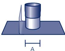
Aus säurefestem Edelstahl V4A mit Schrumpfhülse (max. 100 °C) zur einfachen, sicheren Abdichtung, mit werkseitig eingearbeitetem Anschlussstück aus Polybit Kunststoffbitumenschweißbahn oder aus einem anderen Material (siehe Seite 91)\*
