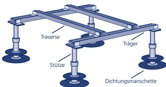
**Trägerstruktur** für Geräte und Anlagen auf Flachdächern, zur Befestigung auf dem Betonuntergrund; freie Höhe 800 mm; Alu, natur; Lackierung in RAL-Farben gegen Aufpreis möglich\*.
