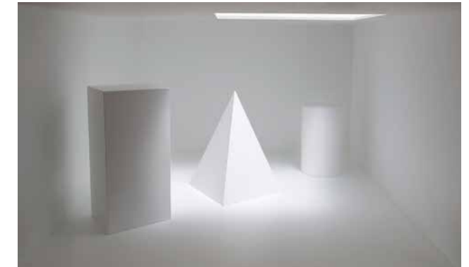
Bei größeren, klaren Oberlichtern und einem weniger gerichteten Lichteinfall wird eine gleichmäßigere Belichtung erreicht.
