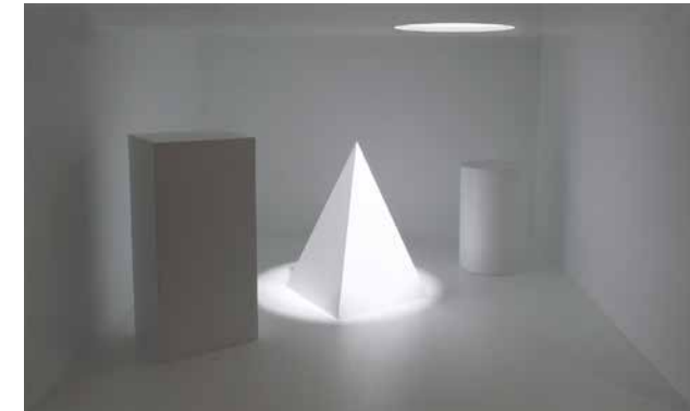
Ein einzelnes, klares Oberlicht erzeugt in Verbindung mit stark gerichtetem Licht eine sehr akzentuierte Belichtung.
