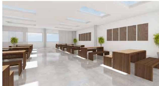
Wenige große Oberlichter in eckiger Form sorgen für die gezielte Anstrahlung der Bereiche darunter.
