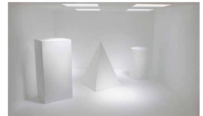
Bei mehreren opalen Oberlichtern und wenig gerichtetem Licht wird der Raum gleichmäßig gut beleuchtet.
