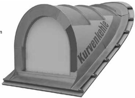
Kurvenkehlen aus Aluminium und Stahlblech farbeschichtet sind im Kehlfalz werkseitig abgedichtet, bei allen anderen Werkstoffen muss der Kehlfalz vor dem Einbau bauseitig durch Lötten abgedichtet werden.
