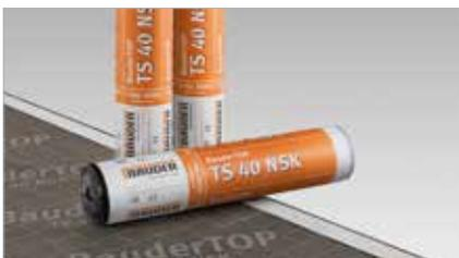
Nicht diffusionsoffene, nahtselbstklebende Bitumen-Unterdeckung zur Verlegung auf Holzschalung unter Bauder Aufsparren-Wärmedämmelemente.  $s_d$  ca. 20 m.
