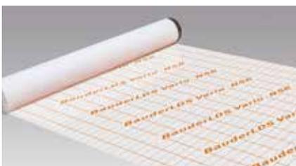
Feuchtevariable Dampfbremse entspr. DIN 4108 Teil 3.  $s_d$ -Wert  $\leq 0,5$  bis  $\leq 10$  m. Breite 1,50 m. Nahtselbstklebend.
